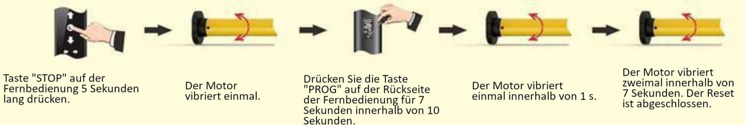
Wenn 30 Sekunden lang keine neuen Signale ankommen, verlässt der Motor automatisch den Modus "Programmierung vorbereiten".
