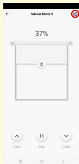
7. Die Taste "OPEN, STOP, CLOSE" für die Motorsteuerung wird auf der Schnittstelle angezeigt. Drücken Sie "Einstellungen".
