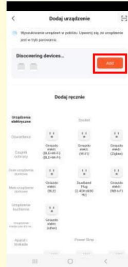
3) Auf der Schnittstelle erscheint die Meldung "device to be added", wählen Sie "go to add". Wenn der Motor nicht reagiert, drücken Sie die "PROG" 4 Mal kurz, einmal lang, um sie zurückzusetzen.
